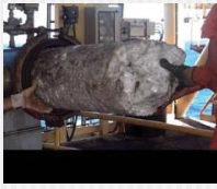
油氣輸送管中的塊狀天然氣水合物 圖片來源： http://www.pet.hw.ac.uk/research/hydrate/hydrates_wbhy.html
