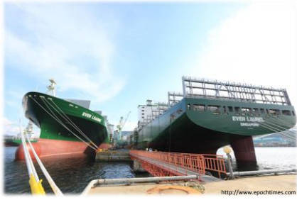
L型貨櫃船可承載8452個小櫃 (TEU)，船身長334公尺，寬45.8公尺，配備有942個冷凍櫃插座，與岸電裝置、壓艙水處理系統、提升主機低速航行效率的電子控制引擎等多項環保設備。
