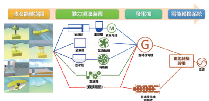
▲ 波浪能發電系統與能量轉換過程
