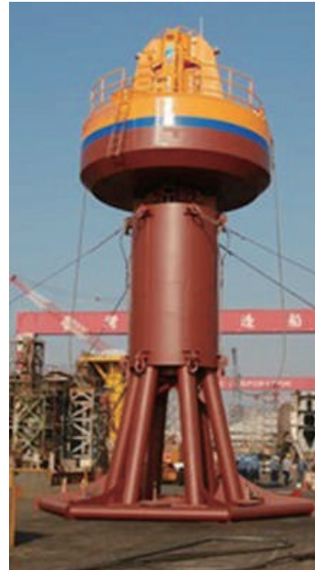
◀ 工研院所開發的懸浮點吸收式波浪發電系統
