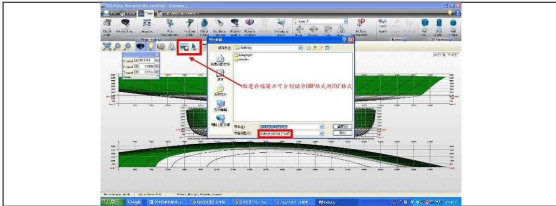
步驟三：將繪製好的船體線圖輸出為\*.DXF 格式或是\*.BMP 格式
