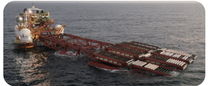
▲ 數百瓩洋流發電機組實海域測試空拍圖
