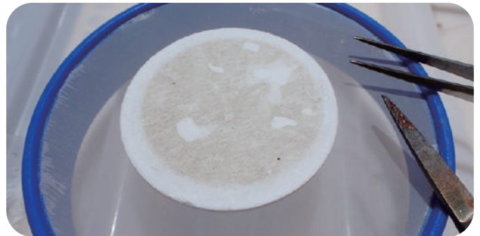
▲ 圖二、過濾1公升溪水後的濾紙，當中摻雜著泥沙、藻類，與許多的eDNA來源物。(圖 / 劉祐辰)
