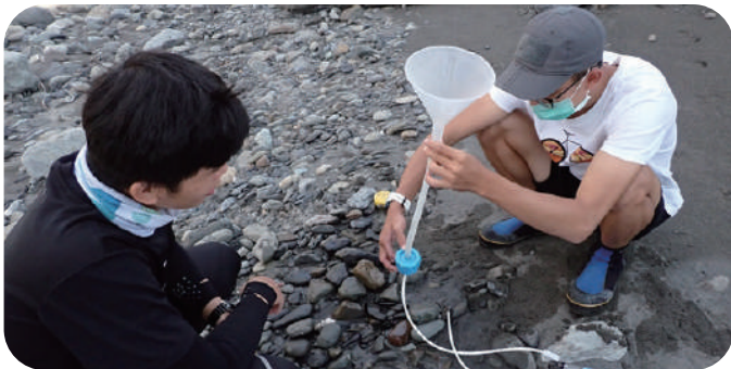
▲ 圖一、水樣中的eDNA來源物常是散落各處的，故通常使用過濾方式進行濃縮；藍色濾頭中夾有濾紙，透過下方幫浦製造負壓，加速過濾進行。 (圖 / 古佳正)
