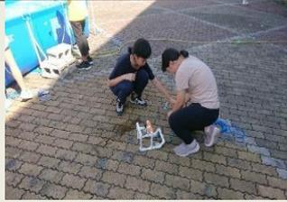
實測後進行機器人配重、移動速度等進行結構修正。
