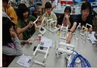
同學依照設計，利用 pvc 水管組成自己的水下機器人。
